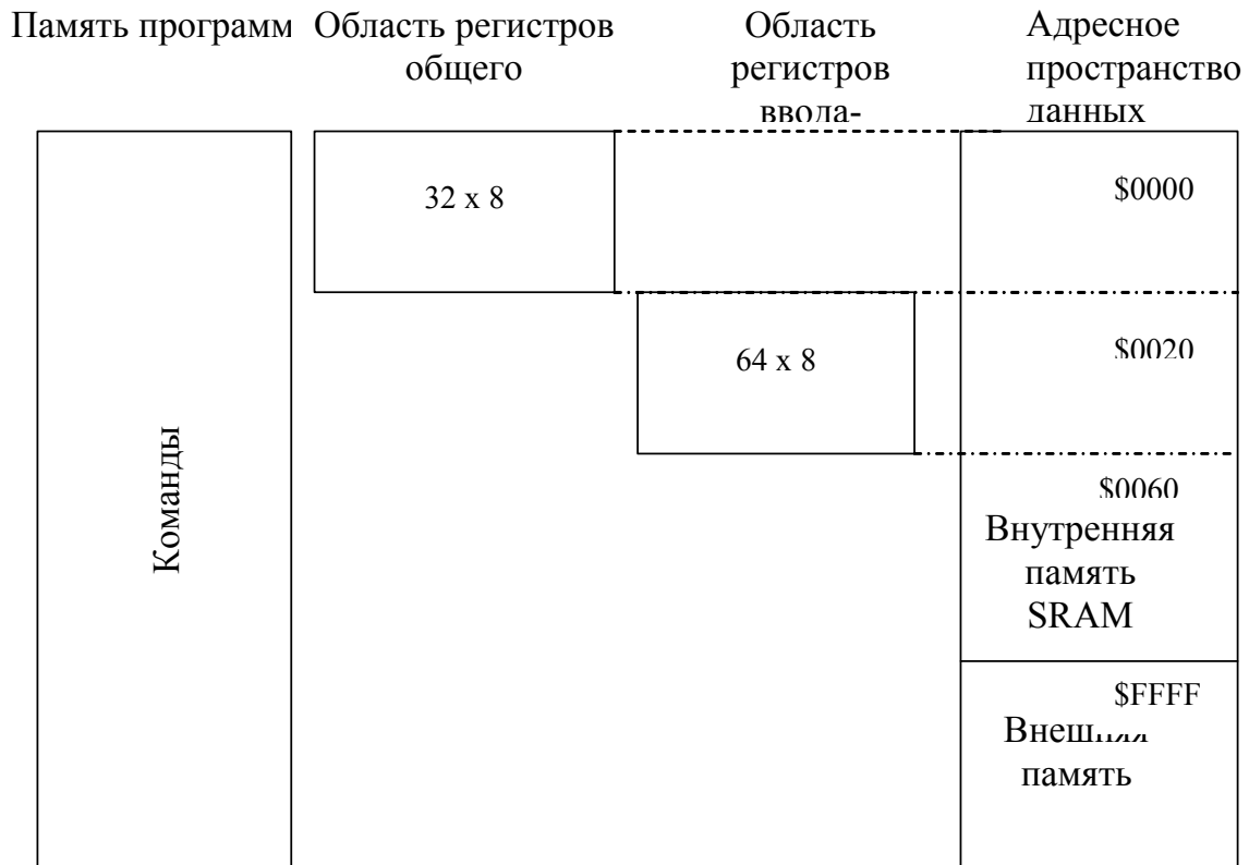
Рис.2. Распределение адресов в микроконтроллере AT90S8515.
