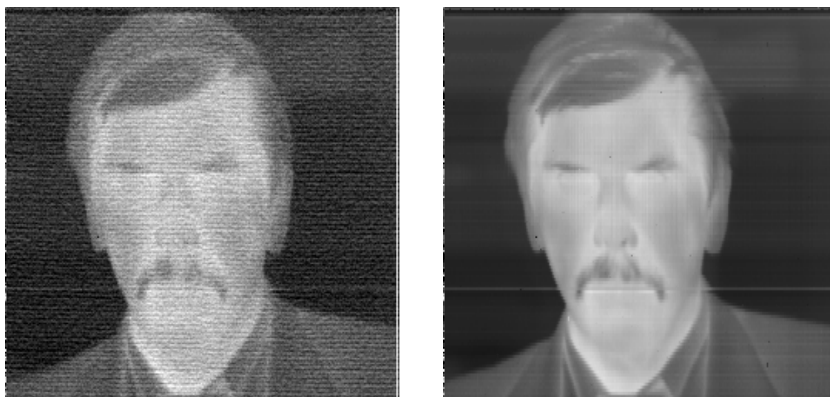
Рис.3. Примеры тепловизионных изображений: без коррекции неоднородностей и после обработки
